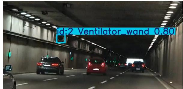
Abbildung 6: Beispielhaftes Ergebnis der Erkennung von Tunnelventilatoren in einem Durchfahrtsvideo. Quelle: RUB
